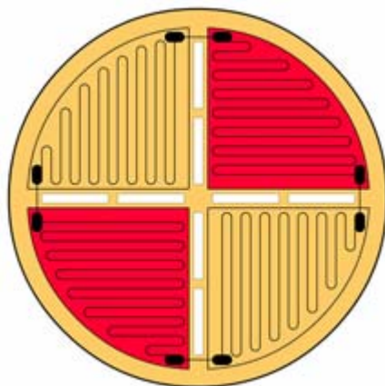
Рис. 2. Чувствительный элемент датчика измерения горючих газов.
